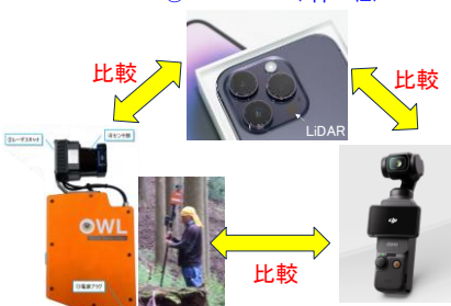
② 森林3次元計測システムOWL (アドイン研究所社) ③ ジンバルカメラ Osmo Pocket 3 (DJI社) + SfM-MVS解析
