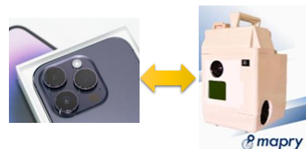
mapry LA01model2... 強み-歩きながら色付き点群データを取得可能。200m測距が可能。 弱み-対象物まで2m以内に近づけない。
