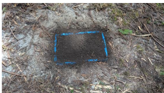
写真-1. 食塩入りの土の設置状況
