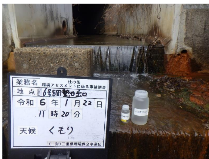
写真 2-1-18 濁水採水状況(No.6) 令和 6 年 1 月 22 日
