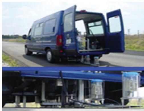
FWDによる健全度診断
