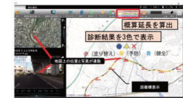
ドライブレコーダーによる 区画線の摩耗判定
