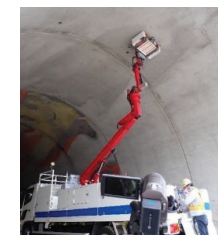
レーザー打音による変状の把握
