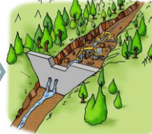
砂防堰堤堆積土砂撤去
