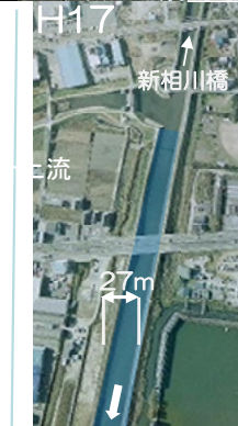
河口部から約900mの引堤完了 次のネック点は、新相川橋！
