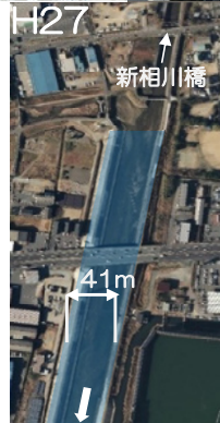
河口部から約900mの引堤完了 次のネック点は、新相川橋！
